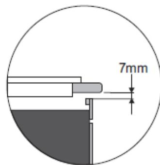
Установка в столешнице рабочей поверхности над духовым шкафом с вентиляцией
