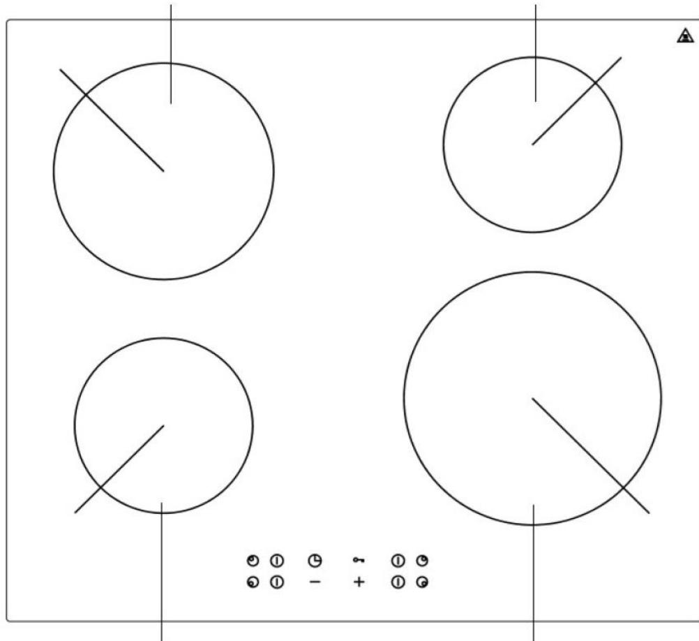
Одиночная нагревательная зона 1200 Вт ( $\varnothing$  148 мм)      Одиночная нагревательная зона 2300 Вт ( $\varnothing$  210 мм)
