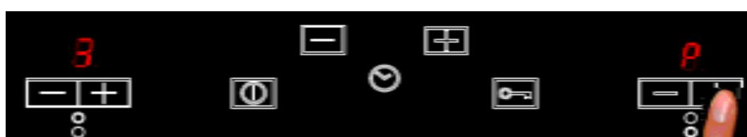
Если включена функция «быстрого приготовления», при нажатии на клавиши [-] появится звуковой сигнал, а степень нагрева изменится до уровня 9.
