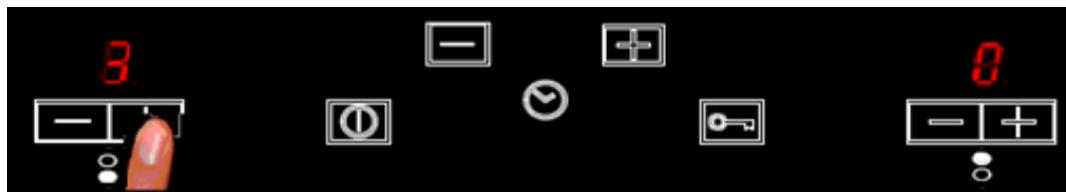
Если конфорка установлена на уровне мощности 0, то после нажатия клавиши [-] степень нагрева изменится на [9].
