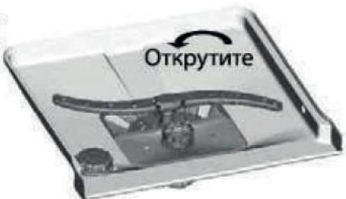
Шаг 1: Поворачивайте фильтр против часовой стрелки
